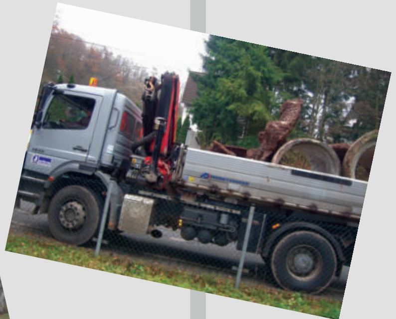
Beginn der Bauarbeiten zum Anlegen eines Infoplatzes der Gemeinde. Schweres Gerät (Lkw mit Kranaufbau) war notwendig für den Abtransport der tonnenschweren Betonrohre
